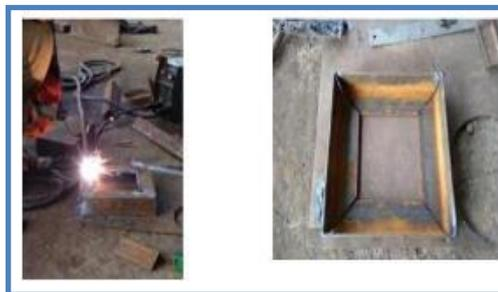
Gambar 9. Mengelas dudukan rangka dan hasil lasan
