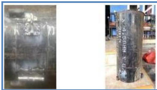
Gambar 4. Penutup outlet dan Hopper atas
