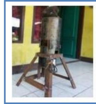
Gambar 14. Hasil *assembly* mesin pemipil jagung
