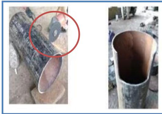
Gambar 3. Pemotongan pipa dan hasil potongan pipa
