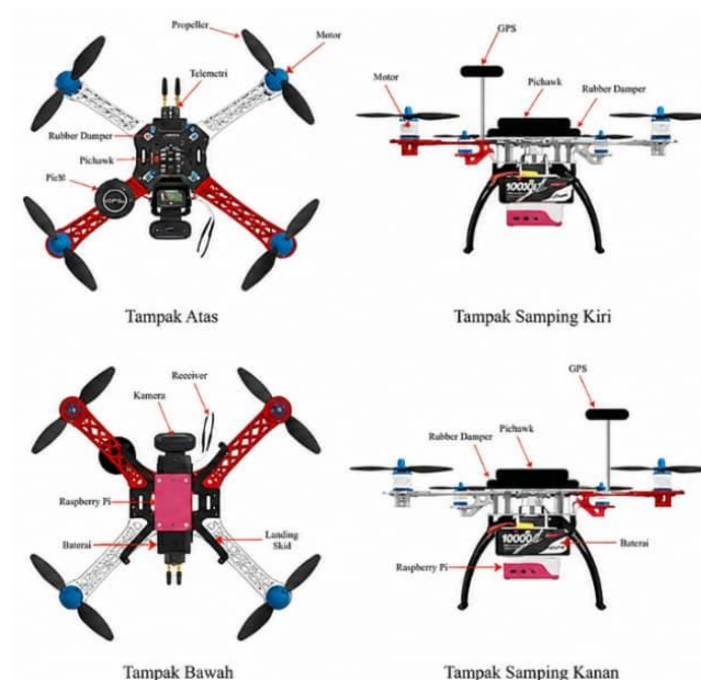
Gambar 1. Skematik rancangan rakitan sistem quadcopter
