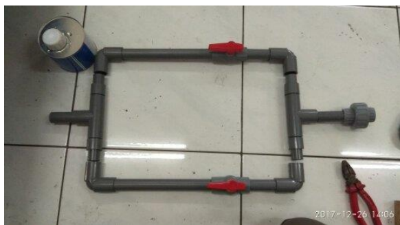
Gambar 5. Penyambungan (perakitan) pipa dengan belokan 90°
