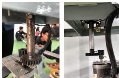
Gambar 3. Sebelum & Sesudah Perbaikan Poros AS
