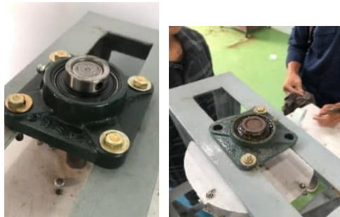
Gambar 4. Sebelum & Sesudah Perbaikan Pillow Block Bearing
